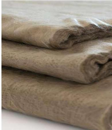
Bazaltna vuna je nezapaljiv izolacijski materijal klase A1. Bazaltna vuna ima izvrstan izolacijski učinak s malom debljinom, pa tako pruža niz mogućnosti za industrijsku izolaciju, ali i za unutarnju izolaciju u stambenoj gradnji.
